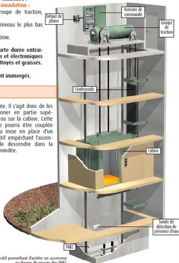
Dispositif permettant d'arrêter un ascenseur au dessus du niveau des PHEC
